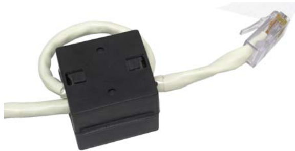
Figura 2-17: Installazione del blocco di ferrite
