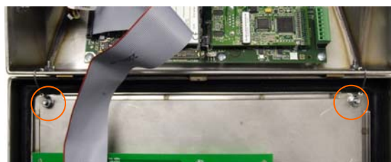
Figure 2-7 : Emplacements de fixation des bandes de mise à la terre
