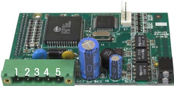
Figura 2-62: Numeración de patillas del tablero opcional DeviceNet
