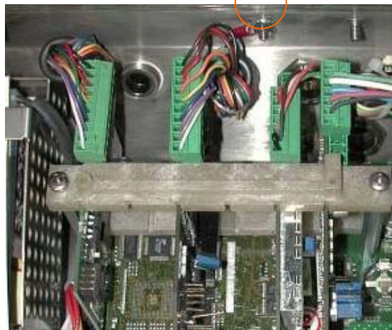
Abbildung 2-20: Abschluss des Abschirmungsdrahts, Gehäuse für raue Umgebungen
