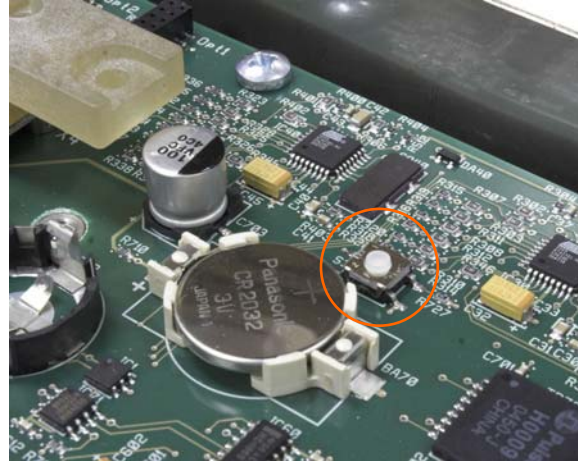
Figure 2-78 : Emplacement du bouton de réinitialisation globale de la carte PCB principale
