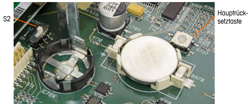
Abbildung 2-78: Position der Hauptrücksetztaste auf der Hauptplatine
