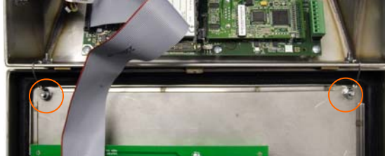
Abbildung 2-7: Positionen der Befestigung des Erdungsbands
