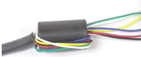
Figura 2-16: Nucleo in ferrite sul cavo di cella di carico analogica
