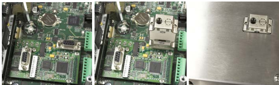
Figura 2-67: Connettore del modulo PLC PROFIBUS per armadietto per montaggio a pannello
