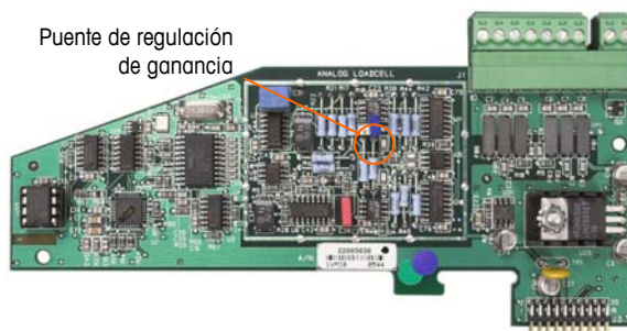
Figura 2-36: Tablero opcional de celdas de carga analógicas
