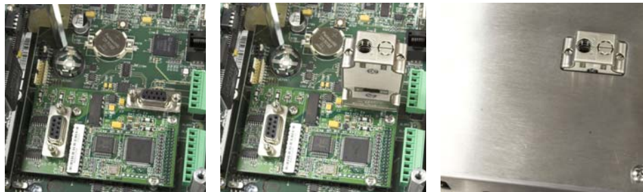
Figura 2-67: Conector de módulo de PLC PROFIBUS para caja para montaje en panel
