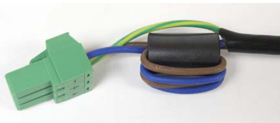
Figura 2-15: Nucleo in ferrite sul cavo di alimentazione per montaggio a pannello
