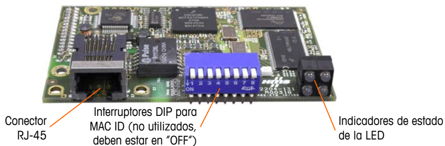
Figura 2-73: Componentes del módulo Ethernet / IP PLC
