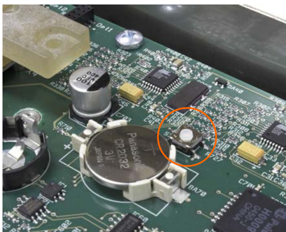
Figura 2-78: Ubicación del botón principal de reinicialización del PCB principal
