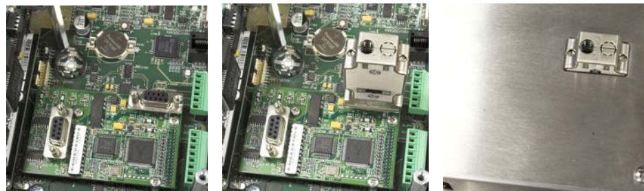
Abbildung 2-67: PROFIBUS PLC-Modulsteckanschluss für das Gehäuse für den Schaltschrank einbau
