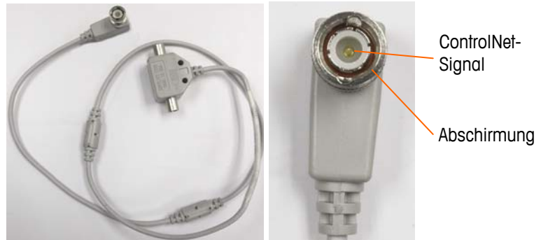
Abbildung 2-71: ControlNet-Kabel und Steckanschluss
