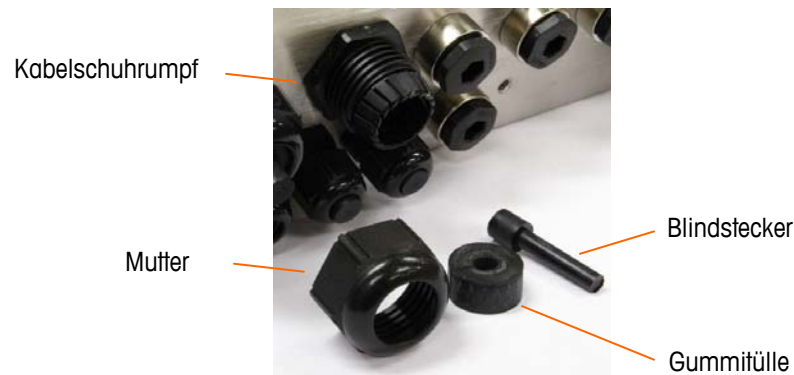
Abbildung 2-22: Kabelstutzenkomponenten
