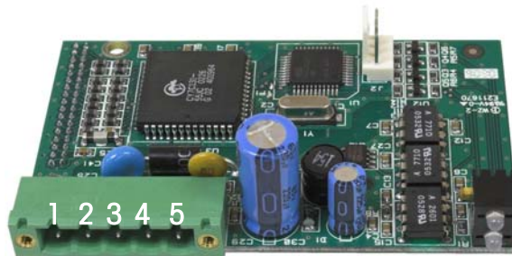
Abbildung 2-62: DeviceNet Optionsplatinensteckers Pin-Nummerierung
