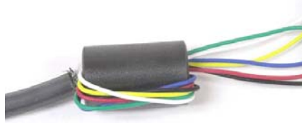
Figura 2-16: Núcleo de ferrita sobre el cable de celda de carga analógica
