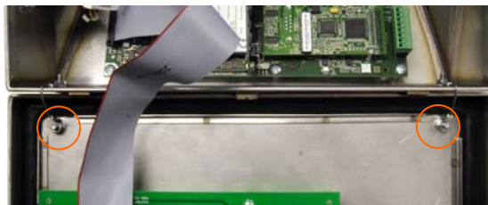
Figura 2-7: Ubicaciones de la fijación de la cinta de conexión a tierra
