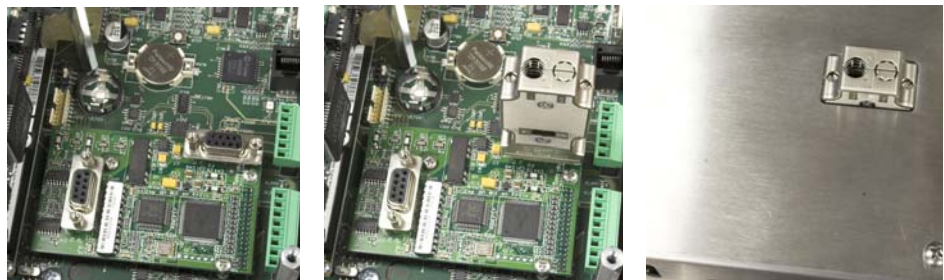
Figure 2-67 : Connecteur du module PROFIBUS PLC (enceinte pour montage sur panneau)
