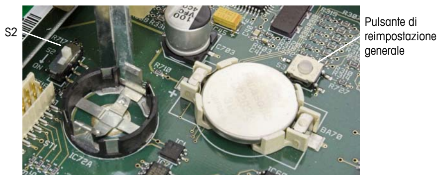
Figura 2-78: Posizione del pulsante di reimpostazione generale sulla scheda madre
