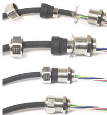
Figura 2-24: Installazione del pressacavo in metallo con la schermatura collegata
