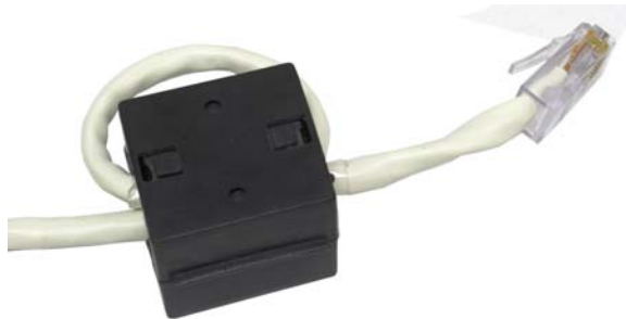
Figure 2-17 : Installation d'une ferrite de type collier
