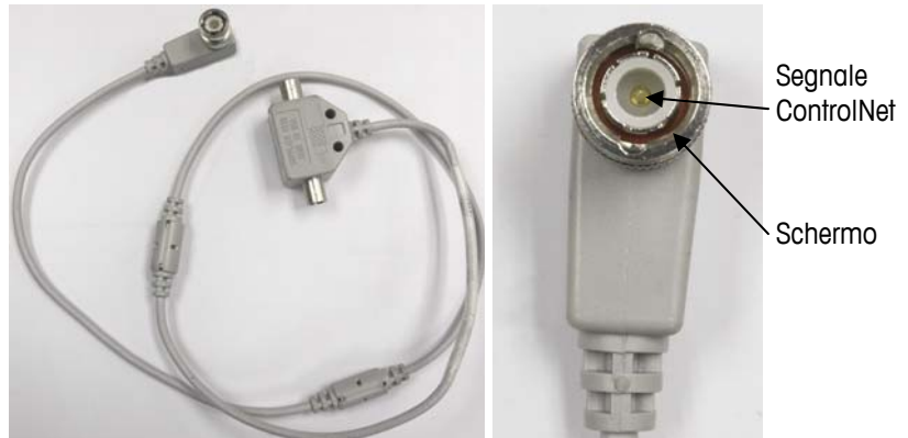
Figura 2-71: Cavo e connettore ControlNet
