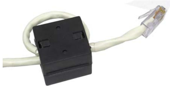
Figura 2-17: Instalación de la ferrita de abrazadera
