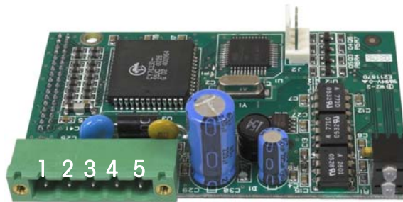
Figure 2-62: Carte d'option DeviceNet numérotage des broches
